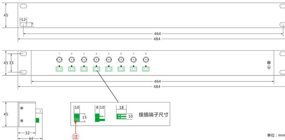
注：此接线孔为螺丝压接固定，建议容纳  $> 0.18\text{mm}^2 < 1\text{mm}^2$  的线缆。
